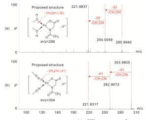
Figure 1. CID mass spectra of (a)  $[{}^{106}PdC_6H_{14}O_5N]^+$  and (b)  $[{}^{106}PdC_8H_{12}O_3N_3]^+.$
